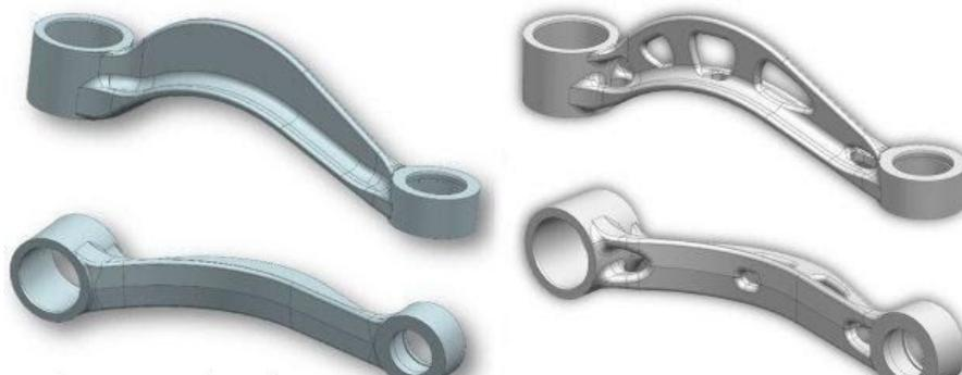
Рисунок 5 – Примеры проектирования детали
